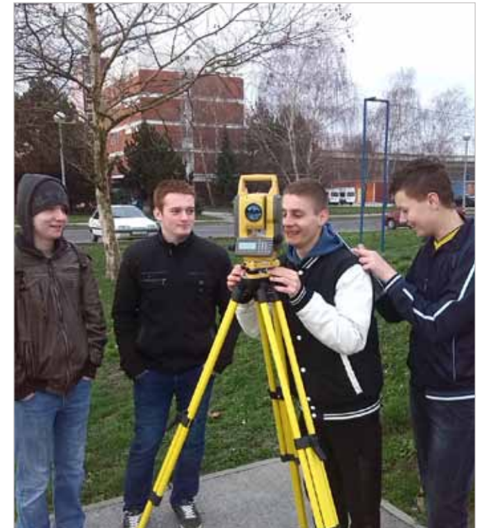
Određivanje duljina i kutova u trokutu pomoću totalne stanice
