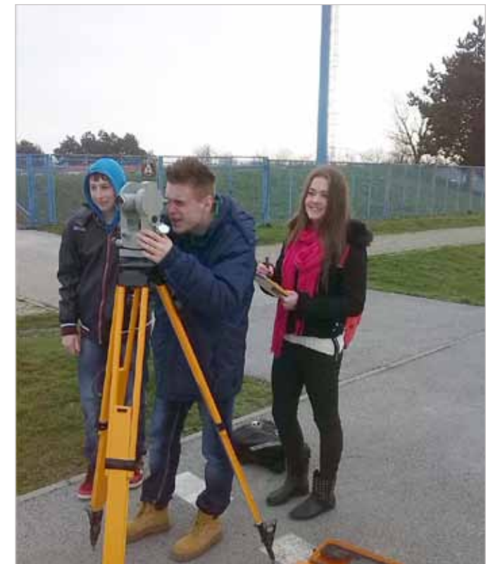
Određivanje duljina i kutova u trokutu pomoću optičkog daljinomjera
