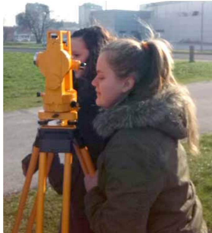
Učenci 1.a razreda izvode vježbu horizontiranja i centriranja instrumenta
