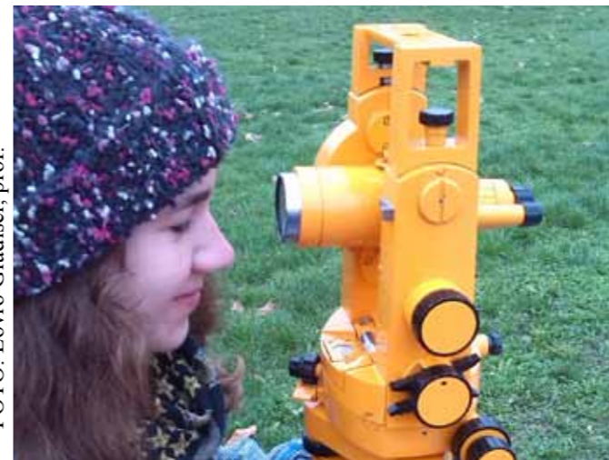
Prije izvođenja Schreiberove metode instrument je potrebno centrirati i horizontirati
